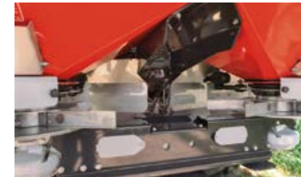
Elektromos működtetésű rendszer a kijuttatási mennyiség szabályozására
