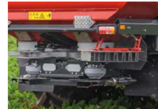
Határszórás – határszórás az ExactLine rendszerrel
