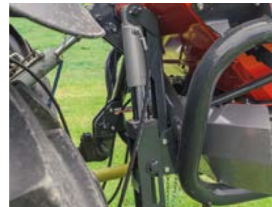
Határszórás billentőhengerral – szórás a határvonal irányába a szélső művelőútról
