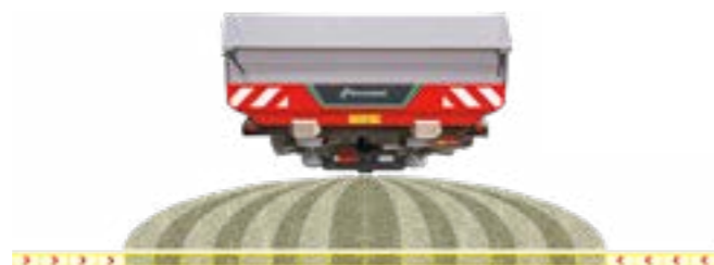
8 méterrel csökkentett szórás szélesség mindkét oldalon
