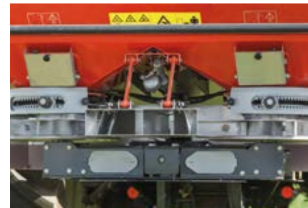
Egyoldali határszórás – szórás a határvonalról a határszóró lemezzel
