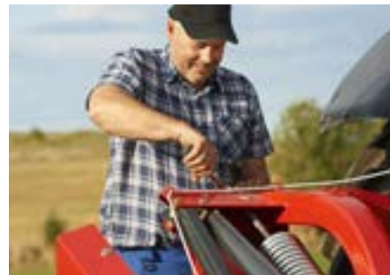
Egyszerűen állítható függesztő rugók.
