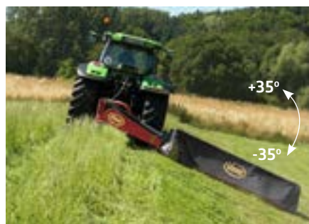
A kialakítás lehetővé teszi a munkavégzést éles szögű működési tartományban.
