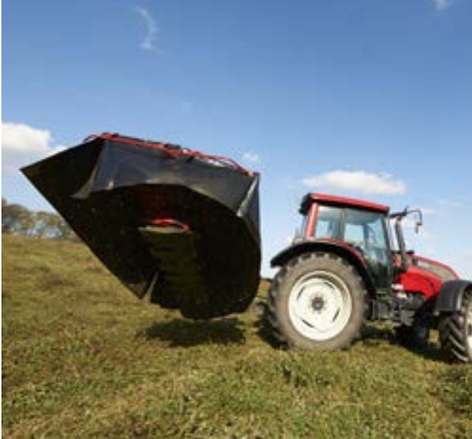
Emelés táblavégi fordulón hidraulikus hengerrel.
