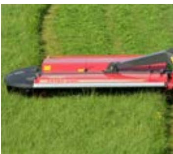
Központi felfüggesztés az egyenletes súlyeloszlás érdekében a teljes munkaszélességben.
