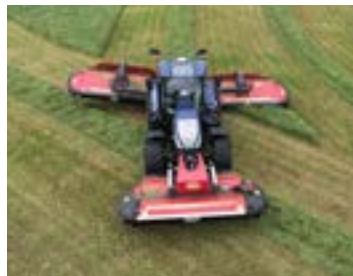
Amennyiben csak egy szalag van használatban, a sebessége csökkentésre kerül a terménynek a középtől való túl távoli eldobásának elkerülése érdekében.
