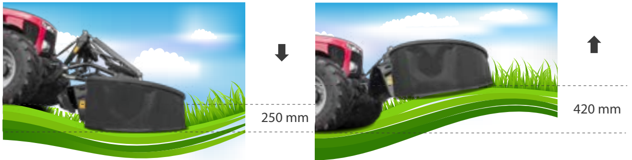
Kiváló talajkövetés 250mm lefelé és 420mm felfelé.
