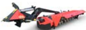
Hátsó függesztésű szársértős fűkaszák 2.42, 2.84 és 3.18m munkaszélesség
