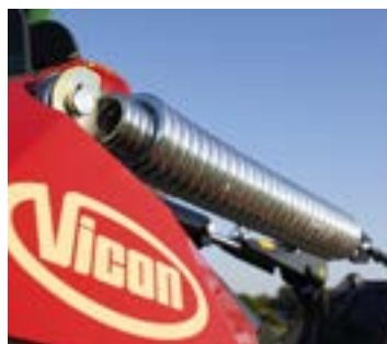
A felfüggesztés rugója biztosítja a tökéletes talajkövetést a kasza teljes szélességében.
