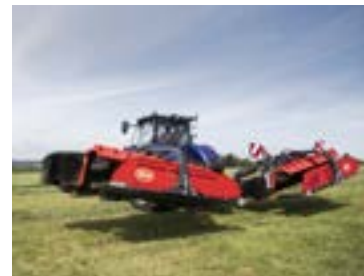
Bőséges hasmagasság a táblavégi fordulónál. Amikor a szalagok kiemelésre kerülnek, azok automatikusan megállnak.
