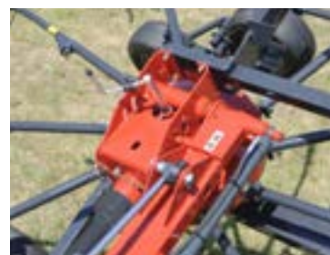
Az Andex 764-en a rotorok hidraulikusan állíthatók 7.00m...
