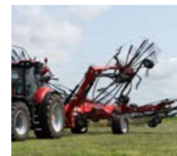
Mind a 4 rotor egyedileg kiemelhető.
