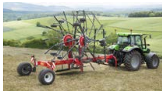
Vicon Andex 1254 Hidraulikusan leengedhető, magasság 4 m alatt.
