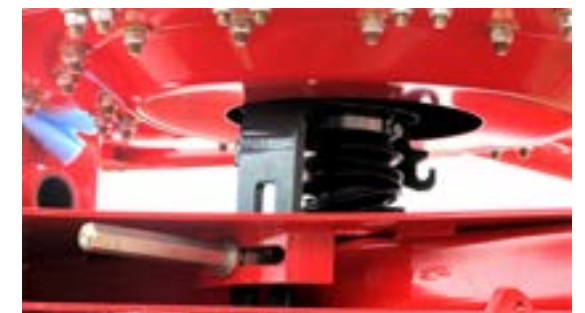
Vicon Andex 1104 ProLine állítható vezérlőpálya.
