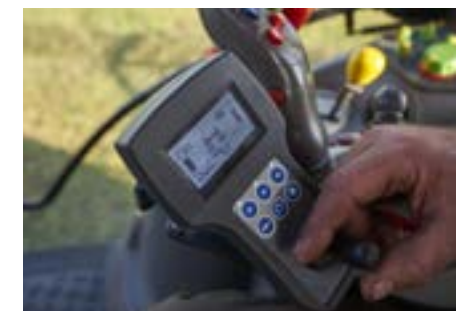
ComfortKit, elektronikusan, külön-külön állítható a rotorok magassága.
