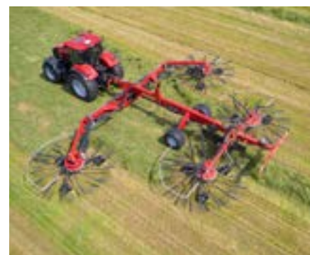
A két külső rotor egyedileg beállítható a 9.8-15.0m munkaszélességhez.
