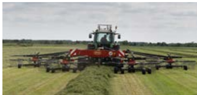
A munkaszélesség 10-12.5m között hidraulikusan állítható. A rendszélesség 1.2 és 2.2m között szintén hidraulikus állítású.
