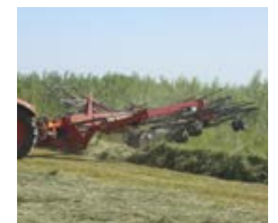
A rotorkarok kiemelése a táblavégi fordulóknál, nagy hasmagasságot eredményez. A hasmagasság fokozatmentesen állítható.
