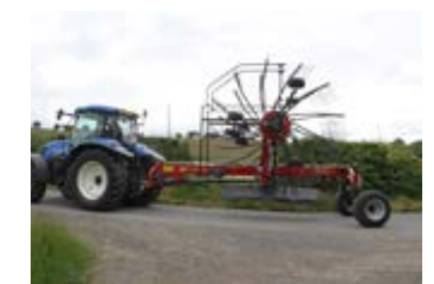
Az Andex 804 szállítási magassága 4,00 m alatt van, és ehhez nem kell elhagyni a traktorfülkét. Az aktív kormányzott hátsó tengelyek éles fordulókat tesz lehetővé munka és szállítás közben.
