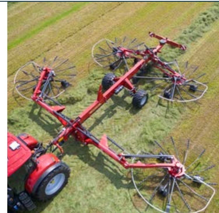
Az egyedi behajtható mellső rotor karok a gépkezelőhöz közel helyezkednek és a gépkezelő jól rálát a fülkéből.
