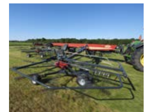
A TerraLink Quattro egy egyedi kombinációja a rugalmas váztag és a 3 dimenziós rotor felfüggesztésnek.
