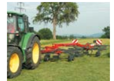
SideShift balra - rendképzés anélkül hogy a földön lévő terményt taposnánk.
