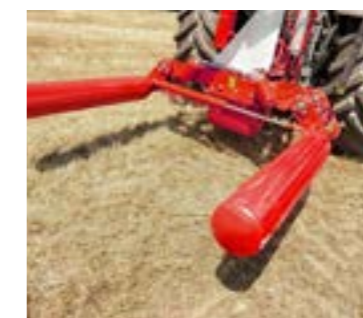
A bálák könnyű és kíméletes önrakodása - a bálát a hengerek finoman emelik fel.
