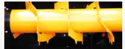
Spirálorotor beépített hidraulika motorral
