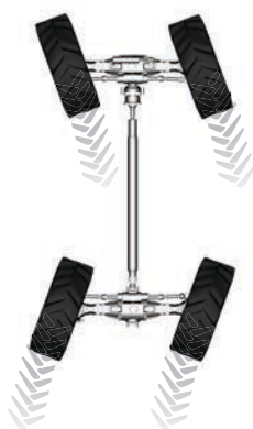
4 kerék kormányzás a manőverezésére, korlátozott helyeken
