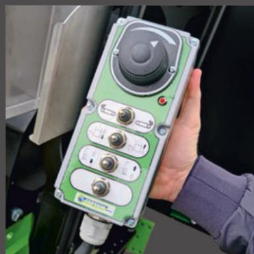
ELEKTROMOS KEZELŐSZERVEK elektromos kezelőpanel, fedélzeti hidraulikával vagy anélkül
