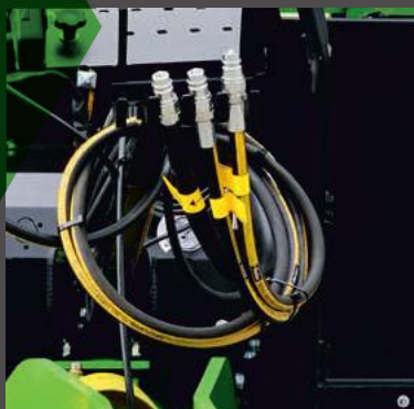
HIDRAULIKUS KEZELŐSZERVEK Traktor hidraulikarendszer használata, fedélzeti hidraulika nélkül (standard)
