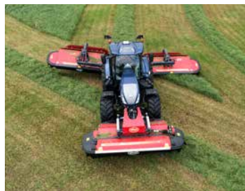
Amennyiben csak egy szalag van használatban, a sebességét csökkentik, hogy a termény ne kerüljön túl távol a középtől.
