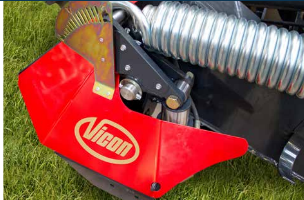
Fel van szerelve az opcionális, hidraulikus talajnyomás állítással.
