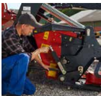
A tarlómagasság egyszerű beállítása.
