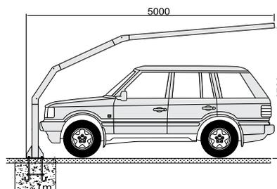
Copertura ombreggiante modulare (passo 5,00 m) protegge le autovetture dal sole e dalla grandine, anche se estremamente violenta. Rivestimento in telo tramato microforato ad alta resistenza.
