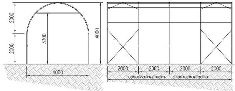
Coperture amovibili ed autoportanti, proteggono il vostro camper, roulotte o furgone. Realizzate ad arco, non richiedono alcuna fondazione. Fissaggio direttamente sul terreno con appositi picchetti oppure su platea in calcestruzzo con tasselli tirafondo.
