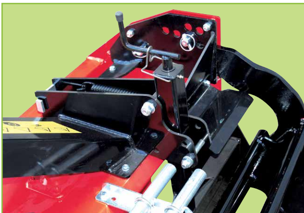
Regolazione rullo laterale manuale per erpici fisse Manuelle Höhenverstellung der Nachlaufwalze für starre Eggen Lateral rear roller adjustment for fixed rotary harrows Régalge du rouleau laterale pour herse rotatives fixes
