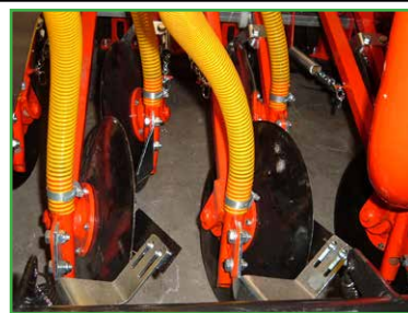
Dettaglio del fissaggio tubi-assolcatori
