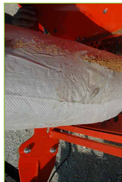
Il sacco dei semi, sollevato con un muletto, viene svuotato su un imbuto ricavato nella pedana posteriore e automaticamente caricato nella tramoggia per mezzo di una coclea.
