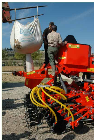
Il sacco dei semi, sollevato con un muletto, viene svuotato su un imbuto ricavato nella pedana posteriore e automaticamente caricato nella tramoggia per mezzo di una coclea.
