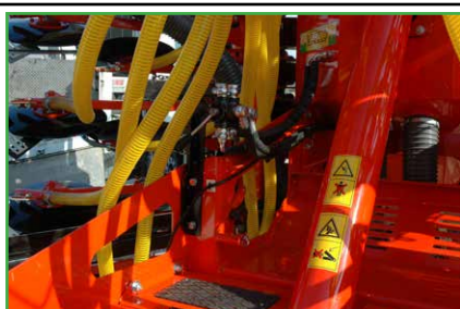
Leva per azionare la coclea di carico seme nella tramoggia
