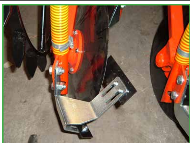
Dettaglio del raschiatore nel disco singolo visto da sopra
