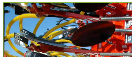
Assolatore a disco semplice con regolazione pressione centrale e singola
