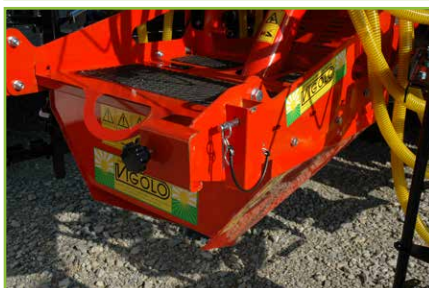
Il sacco dei semi, sollevato con un muletto, viene svuotato su un imbuto ricavato nella pedana posteriore e automaticamente caricato nella tramoggia per mezzo di una coclea.
