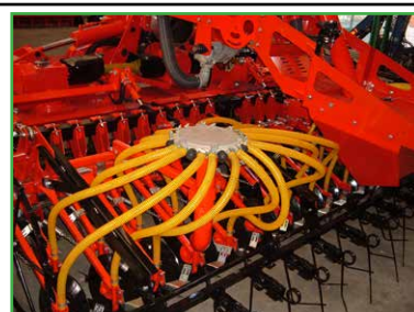
Dettaglio della distribuzione semi
