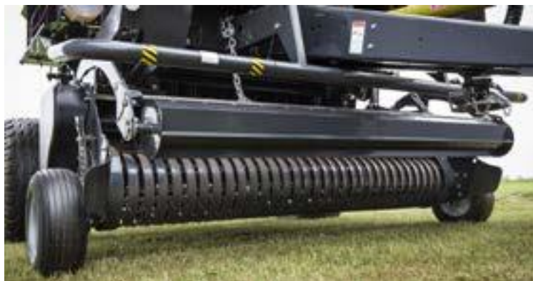
A nagy átmérőjű hengeres terményleszorító elősegíti a terményáramlást nagy behordási sebességnél.
