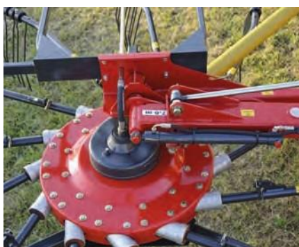
Hidraulikusan állítható munkaszélesség 7,6 m. ....és 8,4 m között.
