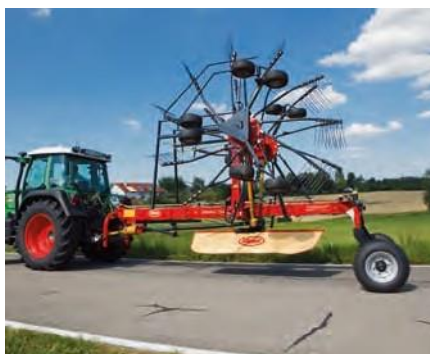
Az Andex középre helyező rendképzői hidraulikusan állíthatóak szállítási helyzetbe, a traktorkabin elhagyása nélkül. A villatartó karok leszerelhetők.
